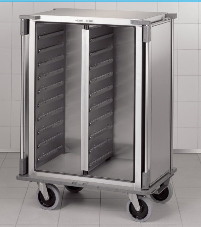
TTW-V 2/40 B-EN zur Aufnahme von Euronorm-Tabletts 530 x 370 mm oder GN-Tabletts 530 x 325 mm. Der Innenraum besteht aus 2 Abteilen zu je 2 x 10 = 40 Tabletts. Der Tablettabstand beträgt 115 mm. Hier abgebildet mit Stoßecken in Kunststoff-Sonderfarbe grau.
